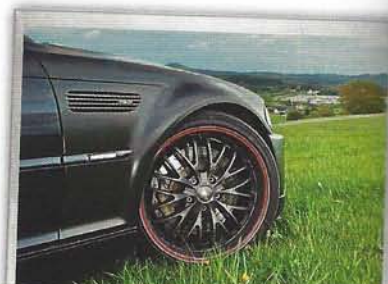
Fede Breyton 19" fælge skjuler de store 365 mm front-skiver og 6-stemplede calipre
